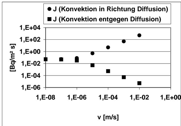
Abbildung 5: Exhalationsraten in Abhängigkeit von der Konvektionsgeschwindigkeit und ihrer Richtung. Die anderen Parameter in den Gleichungen (14) bzw. (17) sind:  $D'=5 \times 10^{-7} \text{ m}^2/\text{s}$ ,  $n=0,3$  und  $C_0=125 \text{ kBq}/\text{m}^3$ .
