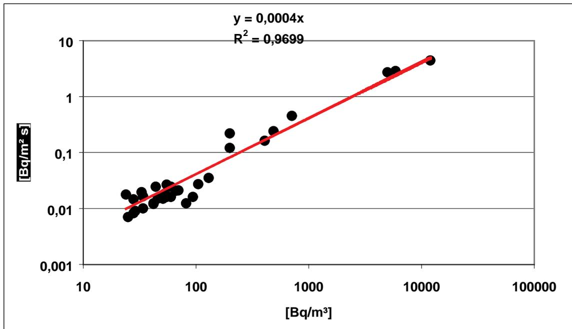
Abbildung 72: Abhängigkeit der gemessenen Exhalationsrate von der in 10 cm Höhe über der Haldenoberfläche gemessenen Radonkonzentration der Halde B, des Damms der Halde und der Trockendammhalde in Johannegeorgenstadt.
