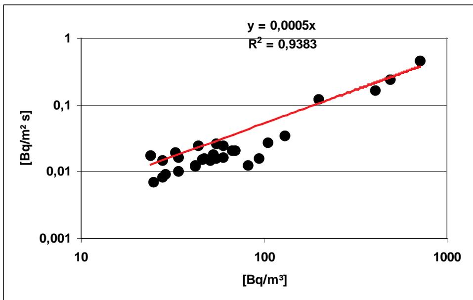
Abbildung 77: Abhängigkeit der gemessenen Exhalationsrate von der in 10 cm Höhe über der Haldenoberfläche und dem Damm gemessenen Radonkonzentration der Halde B.
