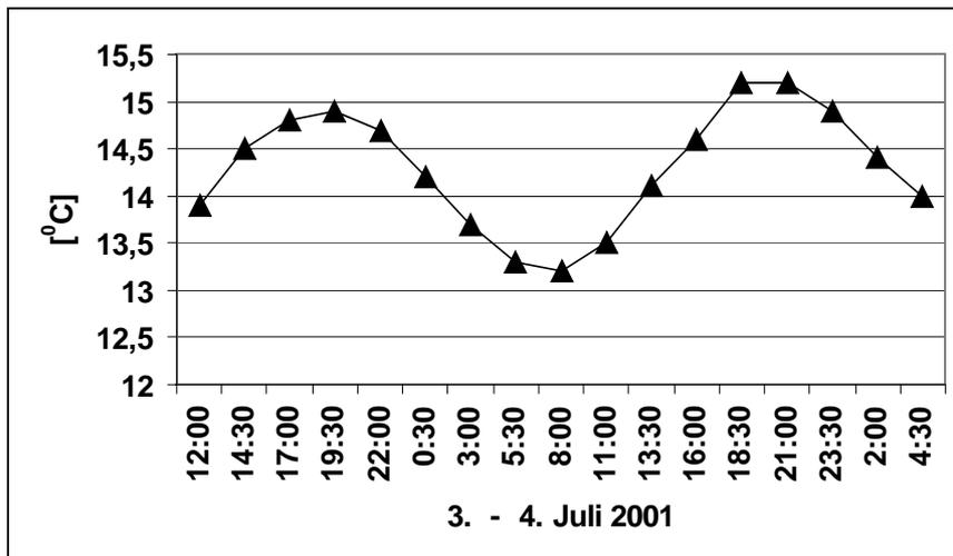
Abbildung 21: Zeitlicher Verlauf der Bodentemperatur für die in Abbildung 19 angegebenen Tageszeiten im Rhythmus von 90 Minuten.
