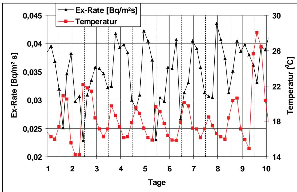
Abbildung 7: Abhängigkeit der Radonexhalationsrate von der Lufttemperatur im Zeitraum von 10 Tagen. Der Meßrhythmus beträgt 4 Stunden. Die gestrichelten senkrechten Linien entsprechen immer 12 Uhr mittags. Der Meßpunkt befindet sich auf dem Betriebsgelände von IAF - Radioökologie GmbH Dresden.
