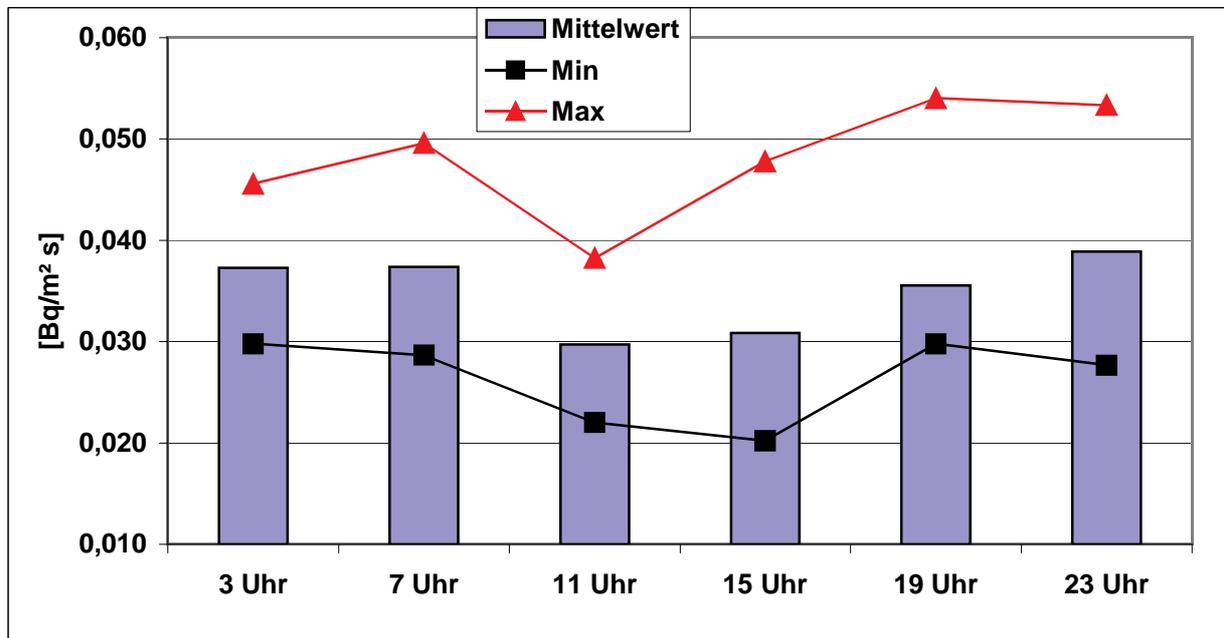
Abbildung 38: Mittelwert, Maximum und Minimum der Exhalationsraten in Abhängigkeit von der Tageszeit (Wiese, Sommerzeit).
