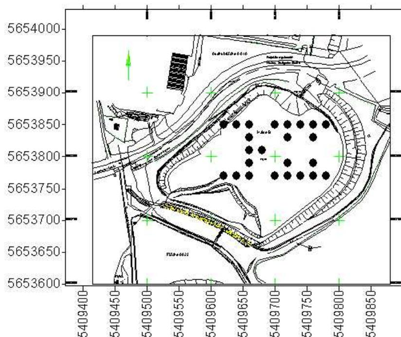
Abbildung 69: Lage der Meßpunkte auf der Halde B an denen Exhalationsmessungen vorgenommen wurden.
