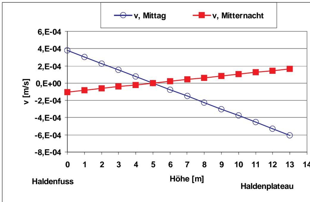
Abbildung 31: Berechnete Konvektionsgeschwindigkeiten für das Modellbeispiel einer Halde (s.a. Abbildung 30).
