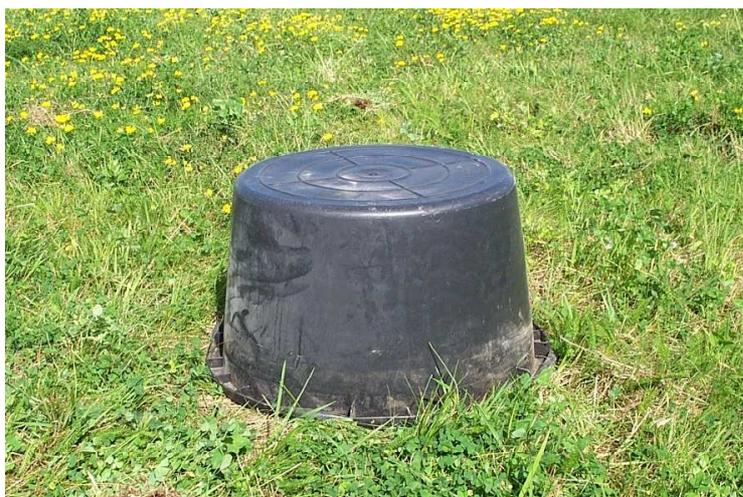
Abbildung 68: In verschiedenen Höhen positionierte Kernspurdetektoren auf der Halde B und Anreicherungsbox zur Bestimmung der Radonexhalation.
