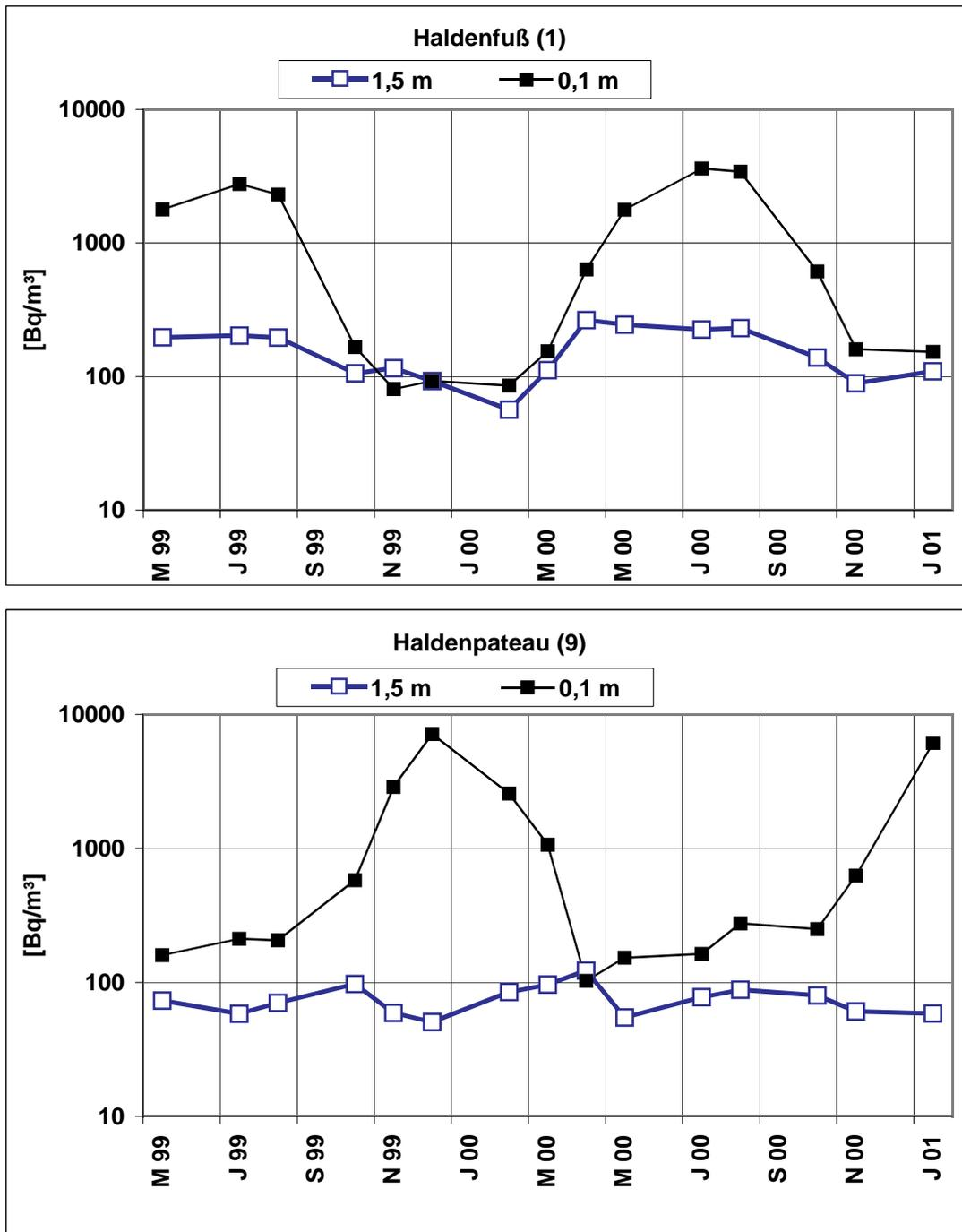
Abbildung 12: Radonkonzentrationen in 10 cm und 1,5 m Höhe über der Haldenoberfläche im Bereich des Haldenfußes und des Haldenplateaus von Mai 1999 bis Januar 2001
