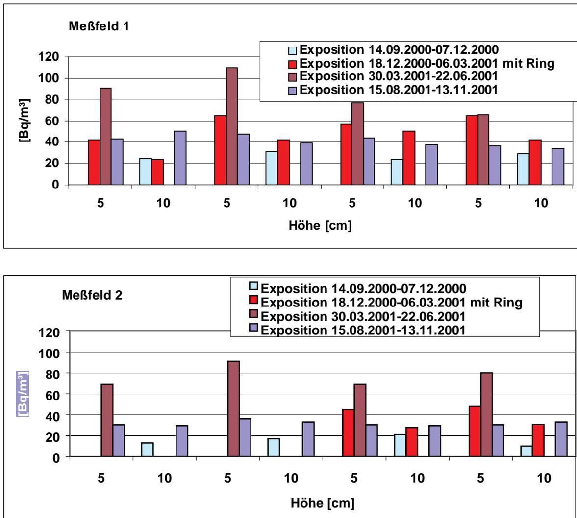
Abbildung 57: Mittlere Radonkonzentrationen über den Meßfeldern 1 und 2 in Abhängigkeit von der Höhe für unterschiedliche Expositionszeiträume. Die Ergebnisse sind in der Reihenfolge der Unterfelder gemäß Abbildung 56 geordnet.
