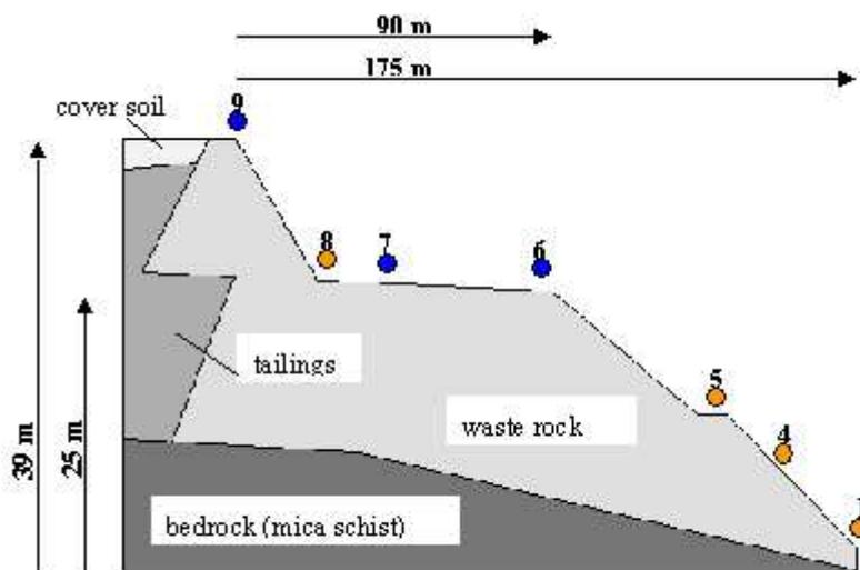
Abbildung 10: Skizzierung des Aufbaus der Trockendammhalde im Steigerdorf
