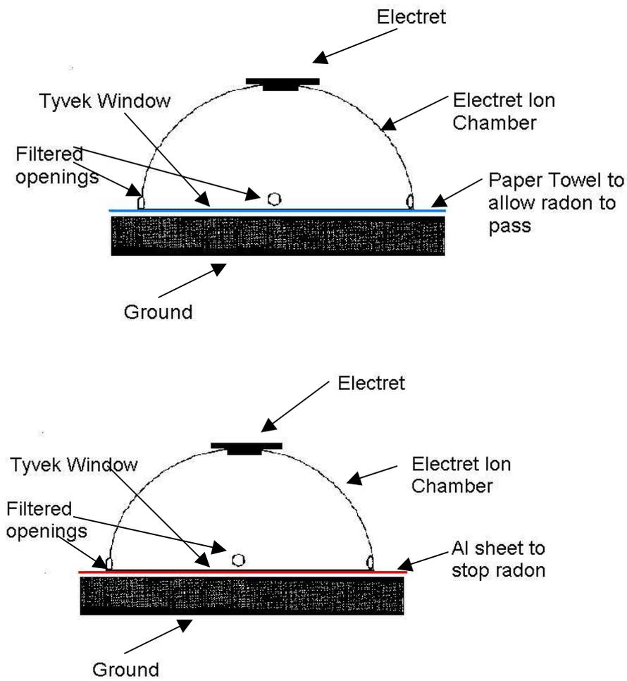
Abbildung 53: Schematische Darstellung eines Radon-Flux-Monitors nach [13]
