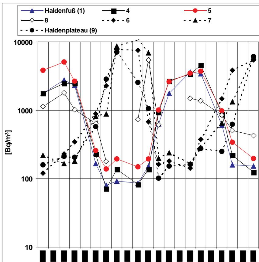
Abbildung 15: Zusammenstellung der Meßergebnisse der Radonkonzentration in 10 cm Höhe für alle Meßpunkte des mittleren Profils.
