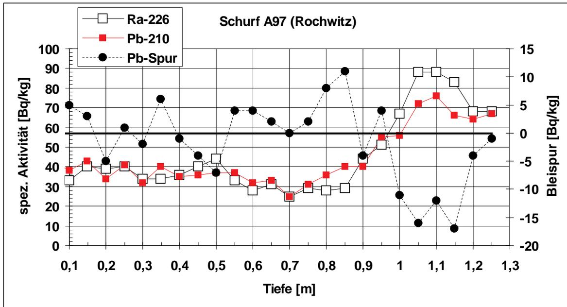
Abbildung 50: Spezifische Aktivität von Ra-226 und Pb-210 sowie der Bleispur (rechte Ordinate),  $A_{\text{Pb-210}} - A_{\text{Ra-226}}$ , in Abhängigkeit von der Tiefe für den Schurf A97 (Dresden-Rochwitz, Ergebnisse aus [1]).
