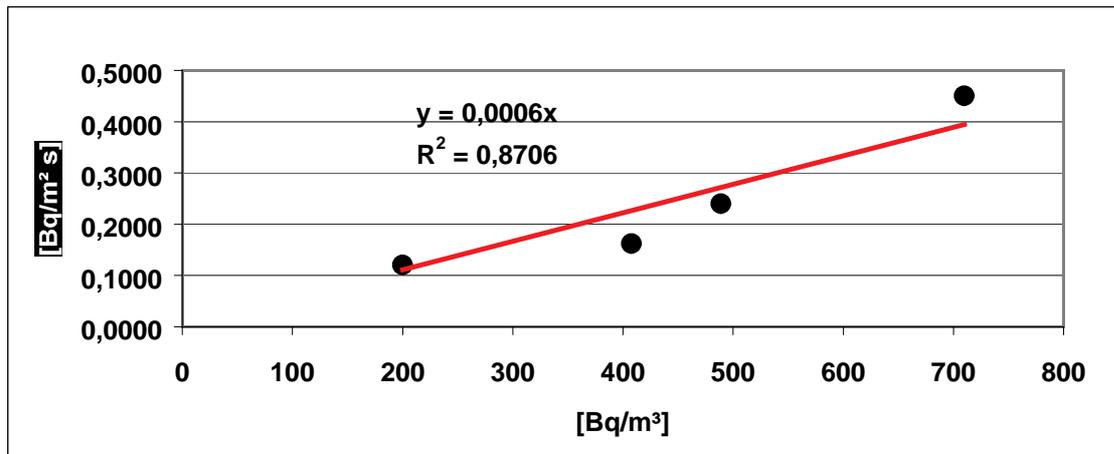
Abbildung 75; Abhängigkeit der gemessenen Exhalationsrate von der in 10 cm über der Dammoberfläche gemessenen Radonkonzentration der Halde B.
