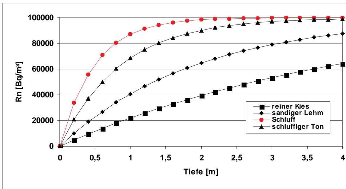
Abbildung 2: Radonkonzentration in Abhängigkeit von der Tiefe für 4 unterschiedliche Bodentypen, wobei der asymptotische Wert der Radonkonzentration in der Bodenluft  $100 \text{ kBq/m}^3$  beträgt.
