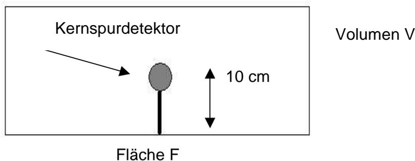
Abbildung 79: Schematische Darstellung eines Kernspurdetektors über einer exhalierenden Oberfläche.
