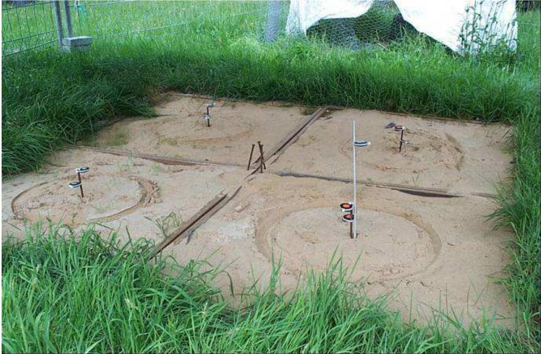
Abbildung 47: Ensemble von 4 Testfeldern in einer umgebenden Wiese. In der Mitte der Felder befinden sich Kernspurdetektoren in Höhen von 5, 10 und 25 cm.
