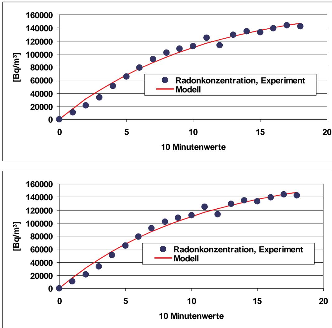
Abbildung 33: Anstieg der Radonkonzentration in der Sammelbox am Haldenfuß (zwischen 16 und 19 Uhr am 3. (oberes Bild) und 4. Juli 2001).
