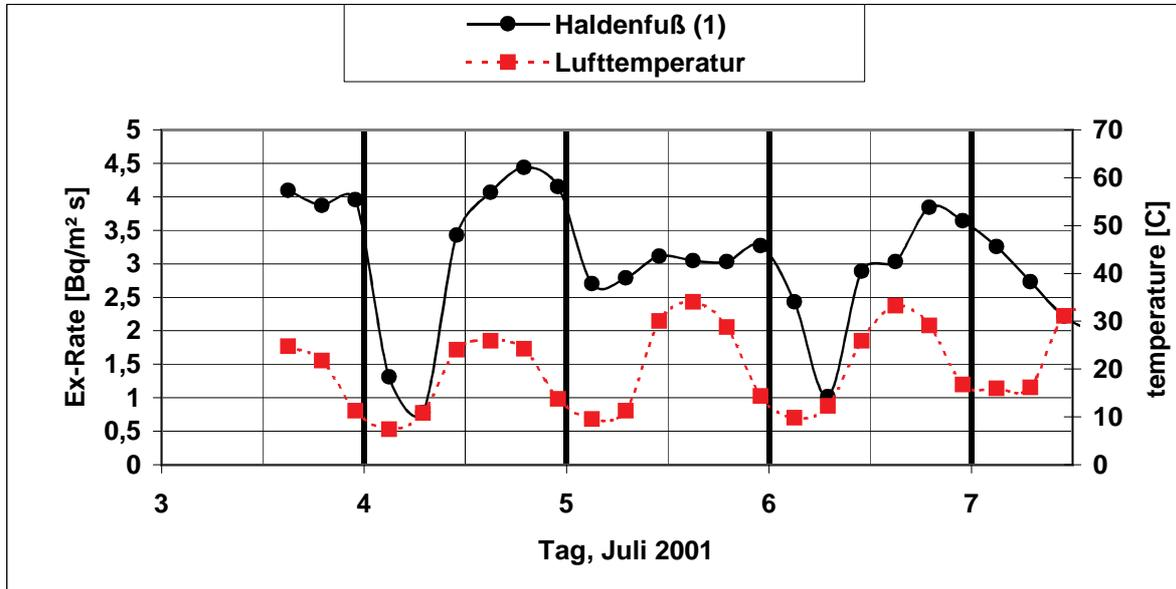
Abbildung 23: Ergebnisse der Exhalationsmessung am Haldenfuß zusammen mit den Werten der Lufttemperatur.
