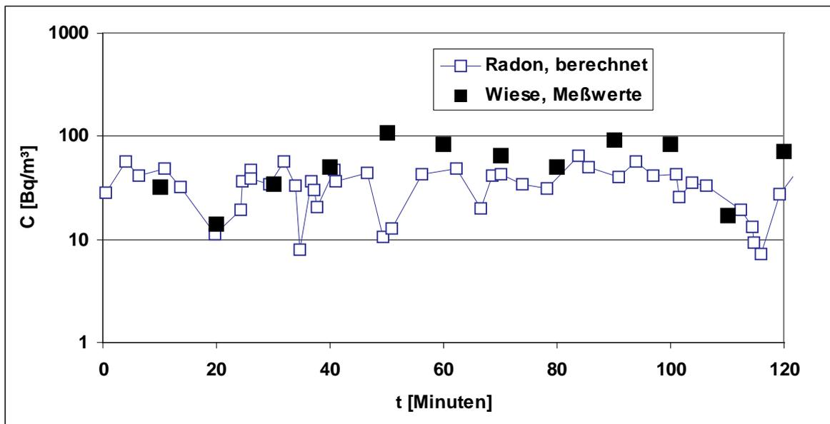
Abbildung 80: Vergleich der mit dem schematischen Modell berechneten Radonkonzentration in 10 cm Höhe mit Meßwerten vom 22.06.02 (01:20 - 03:20).
