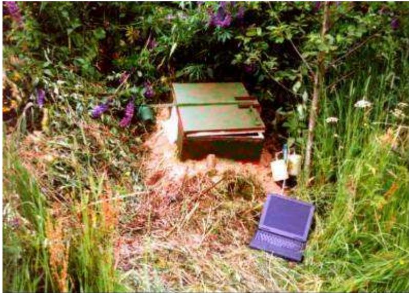
Abbildung 18: Exhalationsmessung am Haldenfuß
