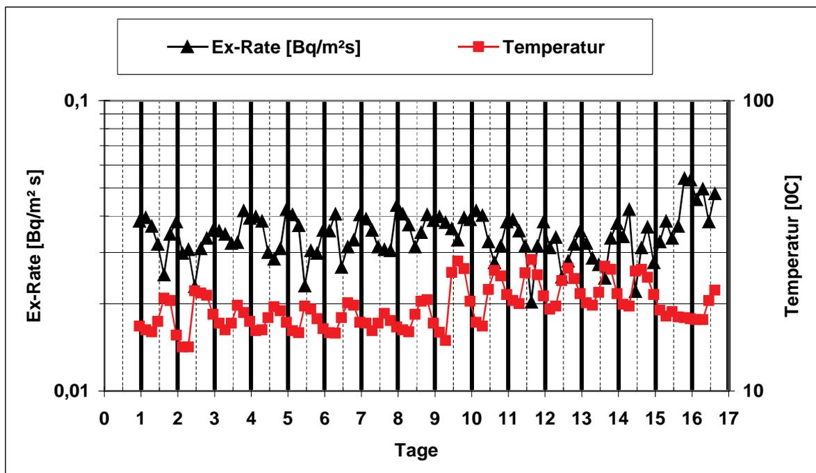
Abbildung 36: Exhalationsrate und Lufttemperatur in Abhängigkeit von der Tageszeit für einen 3-wöchigen Meßzyklus im Juli, August 2000.
